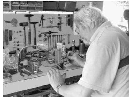
Seine Werkstatt-Ausrüstung in der Garage wuchs mit jeder Bestellung. Der findige keymaker modifizierte auch die Maschinen zu höherer Präzision, indem er umgebaute Schiebleeren und Mikrometer-Messer an die Fräs- und Bohr-Einrichtung montierte und Schablonen für das zurecht Schleifen der Federn ersann.
